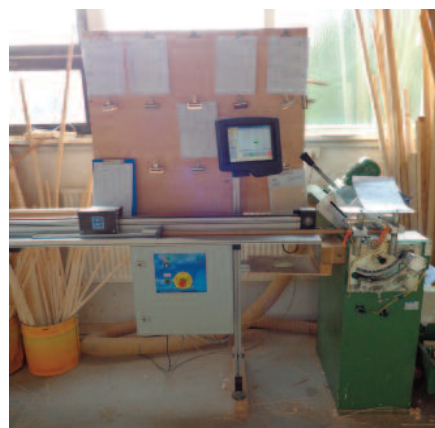
>Oben: Keine komplizierte Maschine, aber für die Schreinerei Wieser eine optimale Hilfe im Arbeitsalltag: Der elektronische Längenanschlag an der Glasleistsäge. Er stellt sich automatisch auf die Daten der Aufträge ein, die vorher geladen werden.
